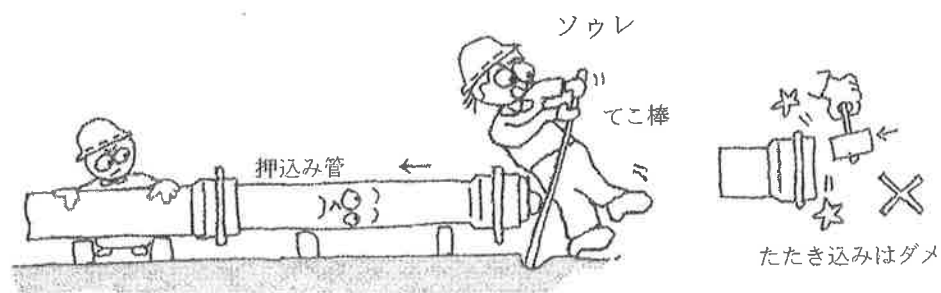
図—6 てこ棒による差し込み
